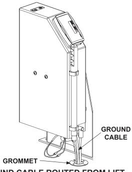
GROUND CABLE ROUTED FROM LIFT FIG. 33-1A
